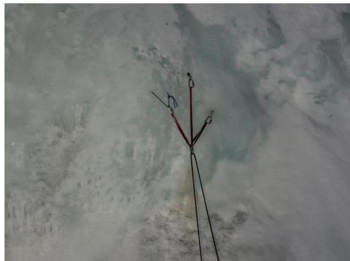
Ледолазание является технически сложным видом спорта и требует постоянной проверки оборудования и снаряжения. С помощью БПЛА были проведены осмотры страховочных станций без нагрузки на них.
